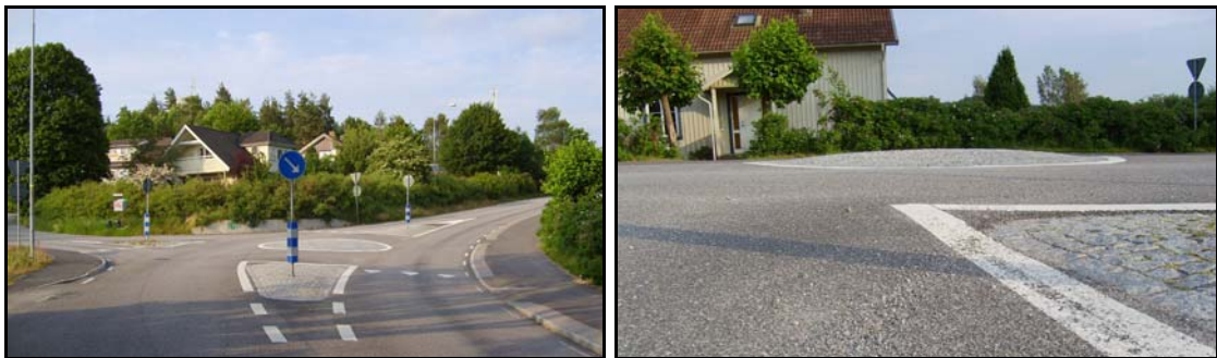
Abb. 17 Minikreisverkehre mit überfahrbaren Mittelinseln (Schweden)
